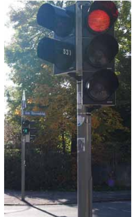
Lichtsignalanlage – Grünzeitvorlauf für Fußgänger
