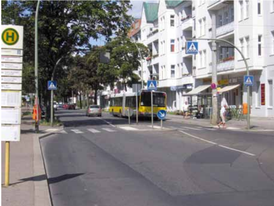
Kombination aus Fußgängerüberweg und Mittelinsel – Verbesserung der Überquerbarkeit und Sichtbarkeit bei großen Straßenbreiten
